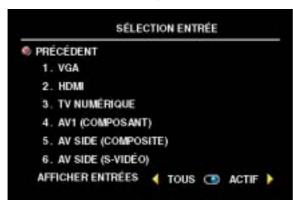
VGA — Sélectionnez VGA lorsque votre ordinateur est raccordé au connecteur VGA. Pour situer le connecteur VGA, consultez la section Vue du bas page 71.
